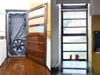
Fig. 5. 기밀성능 및 SHGC 측정
